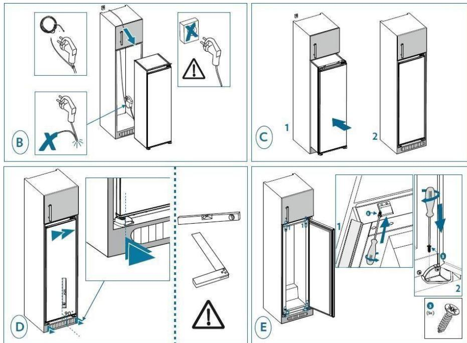
5. Vissez un guide dans les trous du côté de l'appareil. Insérez la glissière dans le guide et vissez-là à la porte. Dévissez le guide pour visser la dernière vis de la glissière sur la porte.
