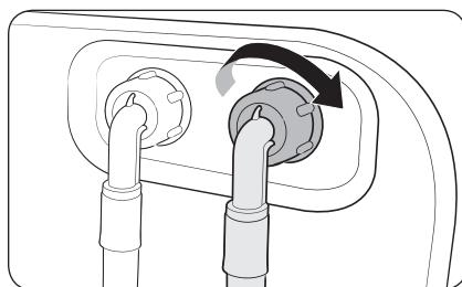
1. Raccordez l'extrémité rouge du tuyau d'eau chaude à la vanne d'arrivée d'eau chaude située à l'arrière de l'appareil.
