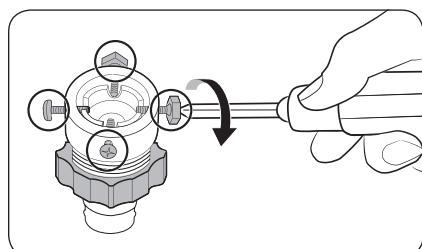
2. Utilisez un tournevis cruciforme pour desserrer les quatre vis de l'adaptateur.
