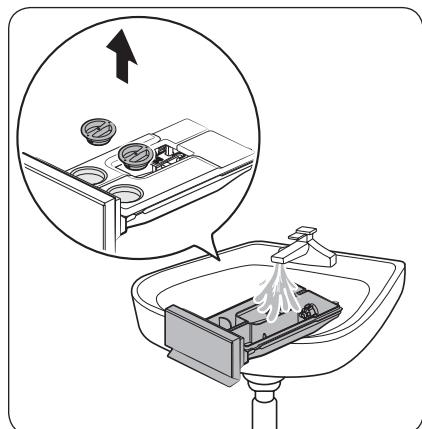
2. Ouvrez les bouchons des distributeurs et nettoyez l'intérieur des distributeurs avec de l'eau.
