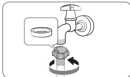
1. Raccordez le tuyau d'eau au robinet d'eau, puis tournez-le vers la droite pour le serrer.
