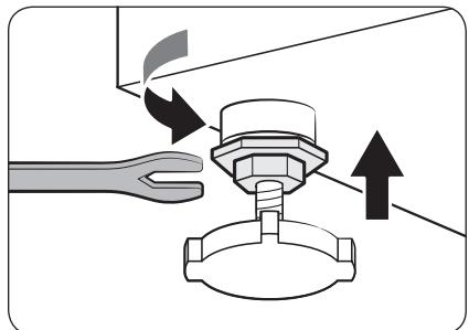
3. Une fois la mise à niveau effectuée, serrez les écrous à l'aide de la clé.
