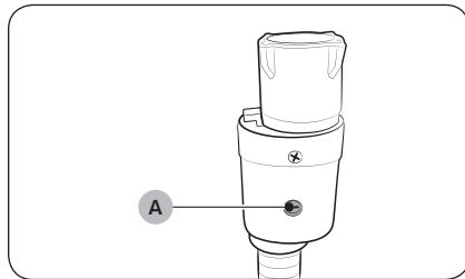
Le tuyau Aqua Stop avertit l'utilisateur en cas de risque de fuite d'eau. Il analyse le débit d'eau et le **voyant rouge central (A)** s'allume lorsqu'il détecte une fuite.
