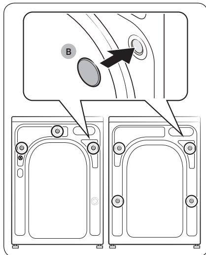
3. Insérez les cache-boulons (B) sur les orifices.
