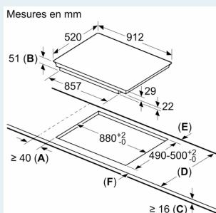
A: Distance minimum entre la découpe de la plaque de cuisson et le mur.
