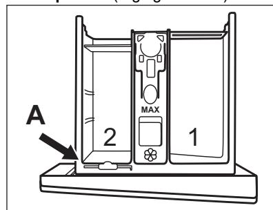
2. Pour utiliser également de la lessive/des additifs liquides ou un agent blanchissant : Sortez le séparateur de détergent de l'emplacement **A** et insérez-le dans l'emplacement **B**.
