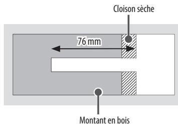
Utilisez une mèche à bois de Ø 4 mm pour percer des trous d'une profondeur de 76 mm. (Nettoyez le trou percé.)
