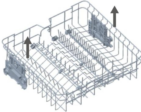
Dans le mécanisme de réglage du panier chargé, assurez-vous que les deux côtés sont dans la même position (haut ou bas).
