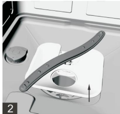
Tournez le filtre central et le micro-filtre dans le sens contraire des aiguilles d'une montre pour les retirer de l'appareil. Séparez les filtres. Sortez le filtre principal.
