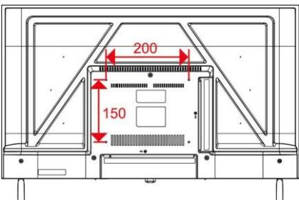
Utilisez des vis standard BM4\*12 (4 vis, non incluses) pour monter ce téléviseur
