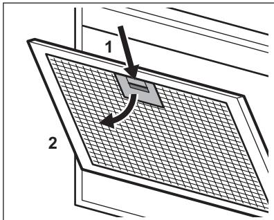
2. Злегка нахиліть передню частину фільтра вниз (2), потім потягніть. Повторіть перші два кроки для всіх фільтрів.
