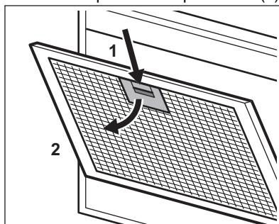
2. Kallutage filtrti esiosa kergelt allapoole (2), seejärel tömmake.
