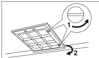
3. Führen Sie zum Einbau des Filters die gleichen Schritte in umgekehrter Reihenfolge durch.
