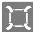
L'aspiration périmétrique optimise l'extraction des fumées et des odeurs en les capturant efficacement sur tout le pourtour de la hotte. Cette technologie assure une purification de l'air rapide et efficace, tout en réduisant le niveau sonore pour une cuisine plus silencieuse et agréable.
