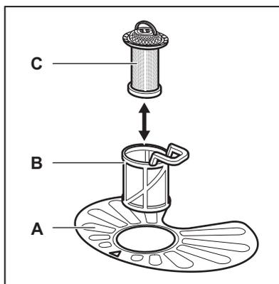
1. Okrenite filter (B) u smjeru suprotnom od smjera kazaljke na satu i skinite ga.
