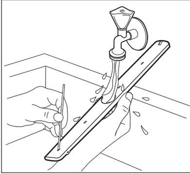
5. Za vraćanje mlaznice (C), umetnite element za montažu (B) u mlaznicu i pričvrstite je na dobavnu cijev (A) okretanjem u smjeru kazaljke na satu. Pazite da element za montažu sjedne na mjesto.
