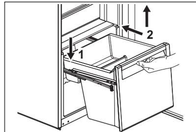
3. Heben Sie den vorderen Teil der Schublade (2) an, während Sie sie hineinschieben.
