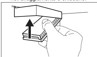
Sostituire il filtro dell'aria ogni 6 mesi.
