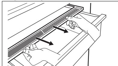
**2. Pentru a înlocui membrana albă a dispozitivului, apucați dispozitivul din**
