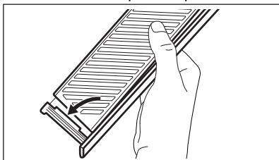
4. Rimonta il dispositivo di controllo dell'umidità sul vano.
