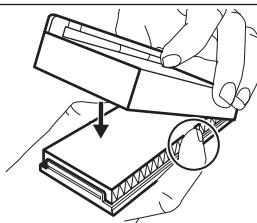
3. Retirez la clayette supérieure en verre du compartiment réfrigérateur. Faites glisser le boîtier en plastique avec le filtre à air sur le côté gauche de l'étagère en verre.
