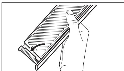
4. Repositionnez le dispositif de contrôle de l'humidité sur le bac.
