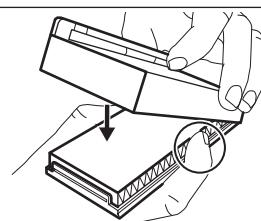
3. Scoateți raftul de sticlă superior din compartimentul frigider. Introduceți carcasa din plastic cu filtrul de aer pe partea stângă a raftului de sticlă.
