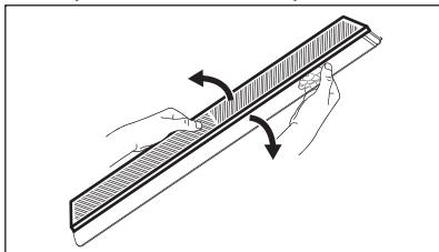
3. Monta una nuova membrana sul coperchio premendo il bordo della membrana sopra il coperchio.
