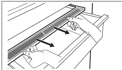
2. Si vous devez remplacer la membrane blanche de l'appareil, prenez l'appareil par le milieu et séparez la membrane du couvercle en tirant sur le couvercle.
