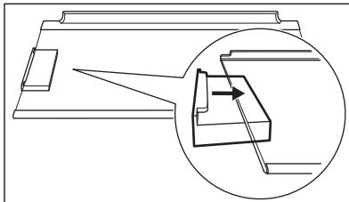
4. Insérez la clayette arrière en verre dans le compartiment réfrigérateur. Ne heurtez pas le filtre.
