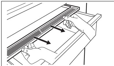
2. Per sostituire la membrana bianca del dispositivo, afferrare il dispositivo al centro e separare la membrana dal coperchio tirando il coperchio.
