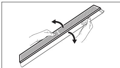
3. Assemblez une nouvelle membrane dans le couvercle en appuyant sur le bord de la membrane dans le couvercle.
