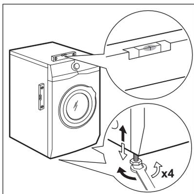
L'appareil doit être stable et d'aplomb.
