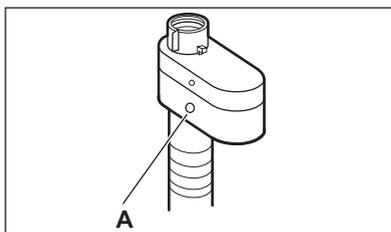
Dans ce cas, fermez le robinet d'arrivée d'eau et contactez le service après-vente agréé pour faire remplacer le tuyau.
