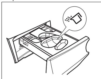
b) Versez la **lessive liquide** dans le même compartiment après avoir inséré le réservoir
