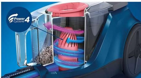
La technologie PowerCyclone 4 accélère le débit d'air dans la chambre cylindrique pour séparer la poussière de l'air et maintenir la puissance d'aspiration plus longtemps.
