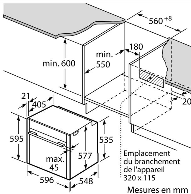
Si l'appareil est installé sous une table de cuisson, les épaisseurs de plaque de travail suivantes (le cas échéant y compris la sous-structure) doivent être respectées.
