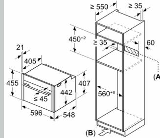
A: Espace pour le raccordement de l'appareil 320 x 115 mm
