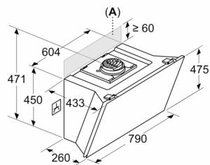
La prise peut être installée sur le côté ou au-dessus de l'appareil
