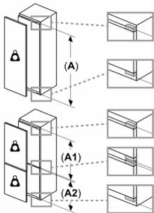
**Poids maximal admissible des façades de l'appareil**
