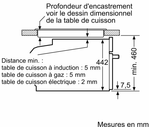
Si l'appareil compact est installé sous une table de cuisson, les épaisseurs de plaque de travail suivantes (le cas échéant y compris la sous-structure) doivent être respectées.
