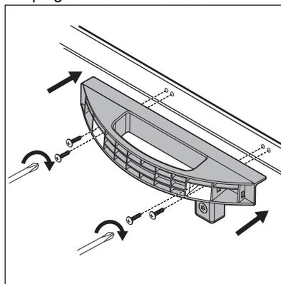
3. Retirez le couvercle de la poignée du sachet en plastique. Pour éviter d'installer le couvercle de la poignée à l'envers, vérifiez la direction du couvercle avant l'installation.
