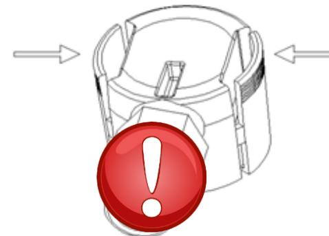
\* Pour positionner et enlever l'adaptateur il faut pincer les 2 côtés fermement et tirer vers le haut, **ceci évitera d'endommager l'adaptateur**
