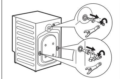
6. Retirez les trois boulons, les supports de tuyau, ainsi que les entretoises en plastique à l'aide de la clé fournie avec l'appareil.
