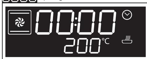
2. Dans un délai de 3 secondes, tournez la manette température pour régler la durée de cuisson (d'1 minute à 13 heures, par exemple « 25 minutes »).
