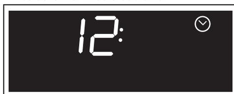
3. Appuyez sur la manette température pour régler l'heure courante et passer à la sélection des minutes.
