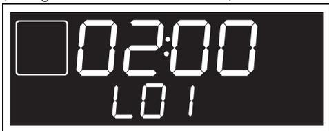
3. Tournez la manette température pour configurer la durée de la pyrolyse d'un minimum de 2 heures à un maximum de 3 heures.
