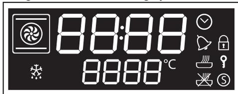
L'afficheur indique les paramètres et les valeurs relatifs à l'opération sélectionnée. Pour l'utiliser, il suffit de tourner la manette fonctions et la manette température pour sélectionner les valeurs indiquées.
