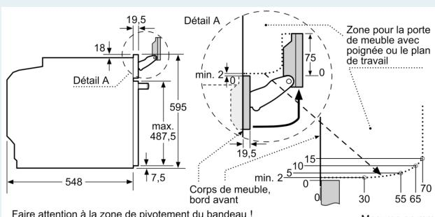
Si l'appareil est installé sous une table de cuisson, les épaisseurs de plaque de travail suivantes (le cas échéant y compris la sous-structure) doivent être respectées.
