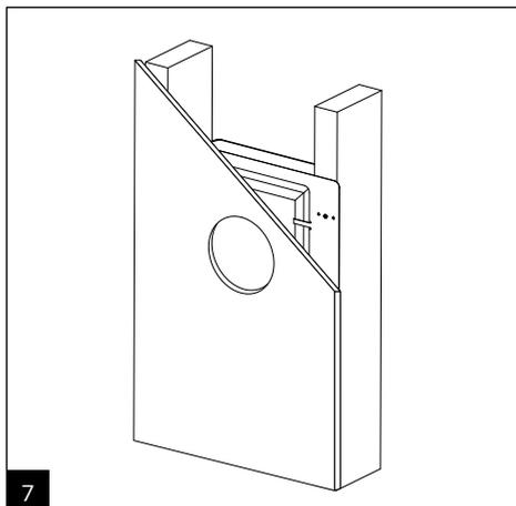
Positionner puis fixer la plaque de plâtre de façon à ce que l'ouverture soit centrée sur le boîtier coupe-feu.
