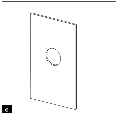
Découper une ouverture sur la plaque de plâtre à l'aide du gabarit de découpe fourni avec l'enceinte à utiliser.
