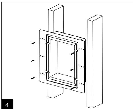
Fixer le boîtier coupe-feu sur les montants/solives en utilisant les trous pré-perçés situés sur les retours latéraux en utilisant au minimum 6 vis de 4 mm de diamètre et 3 cm de longueur. Utiliser une vis sur chaque coin.
