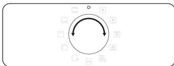
Pendant que la cuisson est en cours, tournez le sélecteur de mode sur « **O** ». Le four s'éteint en quelques secondes. En effet, pour éviter d'accepter des commandes incorrectes de la part des utilisateurs, le four attend quelques secondes pour qu'ils puissent corriger leur sélection.
