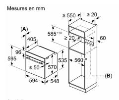
A: 19,5 mm B: Espace pour le raccordement de l'appareil 320 x 115 mm
