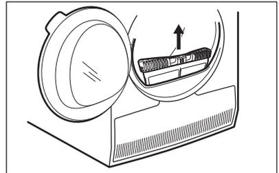
2. Poussez sur le crochet pour ouvrir le filtre.
