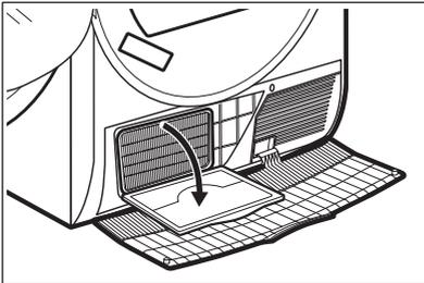
5. Si nécessaire, retirez les peluches sur le condenseur et dans son compartiment. Vous pouvez utiliser un aspirateur avec une brosse.
