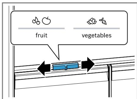
Vous pouvez adapter l'humidité de l'air régnant dans le bac à fruits et légumes en fonction de la nature et de la quantité des aliments à ranger en déplaçant le régulateur d'humidité :
