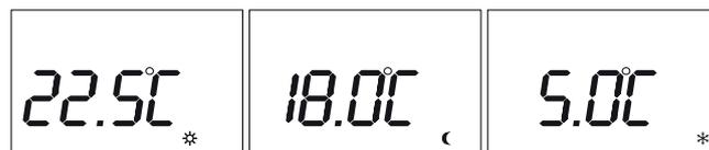
En appuyant sur OK, les écrans des différentes températures de consigne changent : Confort, Eco et Antigel, utiliser les boutons +/- pour changer la valeur et le bouton CONFIG pour confirmer et quitter.
