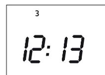
Si le dispositif est relié à une centrale, le réglage de l'heure est annulé et l'heure est configurée par la centrale de manière automatique.
