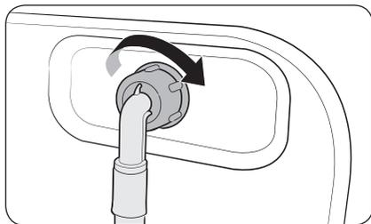
2. Raccordez l'autre extrémité du tuyau d'eau dans la vanne d'alimentation en eau située à l'arrière du lave-linge. Tournez le tuyau dans le sens horaire pour le serrer.
