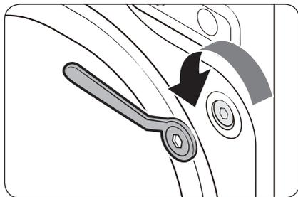
1. Desserrez tous les boulons de transport situés à l'arrière de l'appareil à l'aide de la clé fournie.
