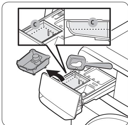
Retirez d'abord le compartiment à lessive liquide fourni au niveau du ➔ **compartiment de lavage principal**. Ensuite, ajoutez de la lessive en poudre dans le compartiment de lavage principal, conformément aux instructions du fabricant de la lessive.
