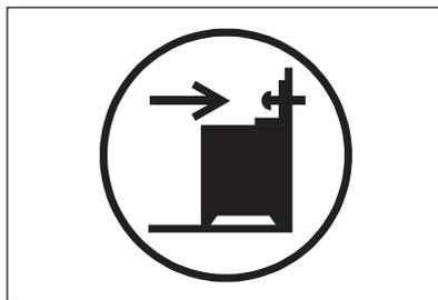
1. Installez la protection anti-bascule 317 - 322 mm en dessous de la surface supérieure de l'appareil et de 80 à 85 mm du côté de l'appareil, dans l'orifice circulaire situé sur un support. Vissez-le dans un matériau solide ou utilisez un renfort adapté (mur).
