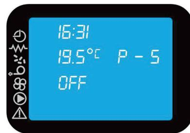
**i** En cas de première mise en service ou après une alarme due à un manque de granulés: garder à l'esprit que la vis d'alimentation en combustible est vide. Un laps de temps est donc nécessaire pour permettre son remplissage et l'alimentation du brûleur. Pour cela, utiliser la fonction [CHARGE INITIAL] du menu.
