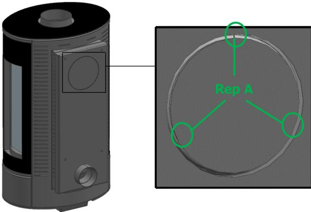
En cas de raccordement arrière, couper les attaches **Rep A** à l'aide d'une pince coupante puis enlever l'obturateur.
