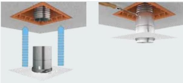
Amener au plafond le raccord monté sur la plaque et positionner
