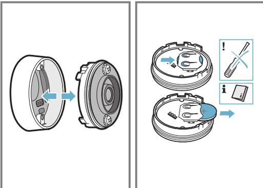
3. Mettre en place une nouvelle pile en observant les instructions relatives aux pôles de la pile. Utiliser uniquement des piles de qualité de type CR2032.
