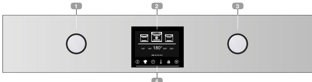
**1** Comando per navigare nei menu della parte sinistra del display. Selettore modalità di cottura.
