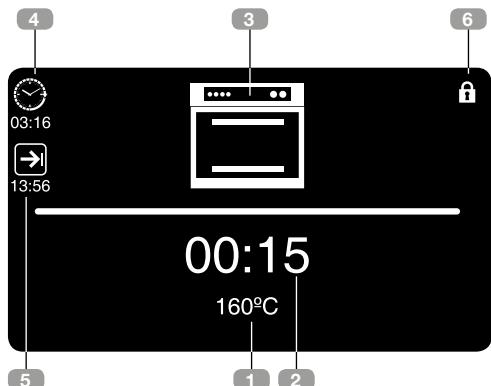
Durante la cottura, le informazioni sullo stato del forno saranno visualizzate sul display:
