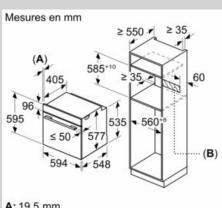
A: 19,5 mm B: Espace pour le raccordement de l'appareil 320 x 115 mm
