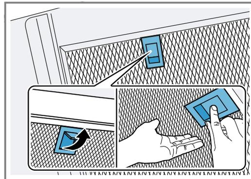
**2. Retirez les filtres à graisse des fixations.**
