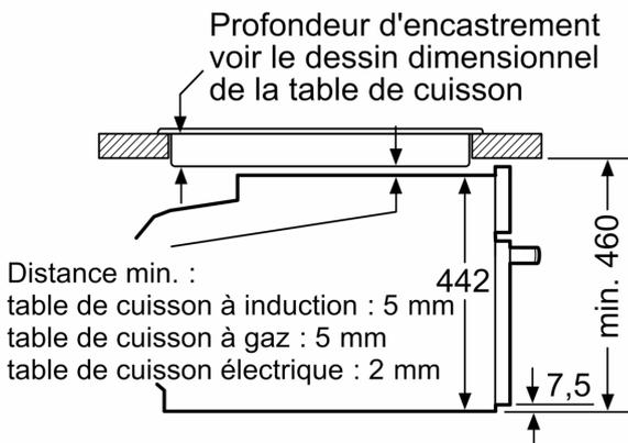
Si l'appareil compact est installé sous une table de cuisson, les épaisseurs de plaque de travail suivantes (le cas échéant y compris la sous-structure) doivent être respectées.
